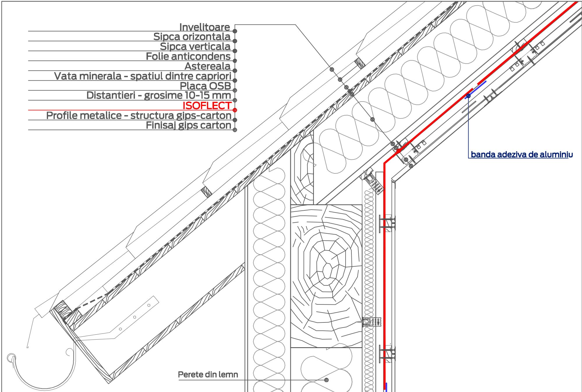
GOLD pe placa de OSB + izolare pereti structura lemn
